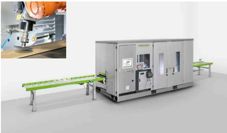
Die TRC Manufactory fräst und schleift gespachtelte und formatierte Einzelelemente individuell.
