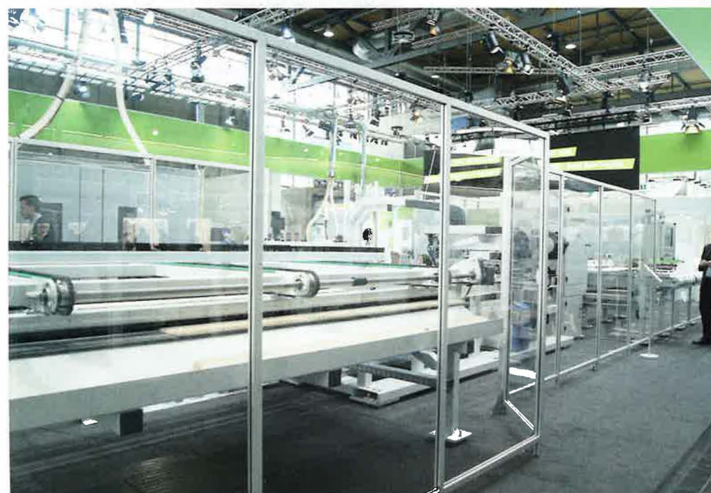
TRC 1500 pozwala po raz pierwszy na całkowicie automatyczną naprawę warstw wierzchnich. Obróbce można poddać powierzchnie drewniane o długości 500 - 3000 mm, szerokości 100 - 350 mm oraz grubości 3 - 30 mm. Fot. Alicja Bagnucka
