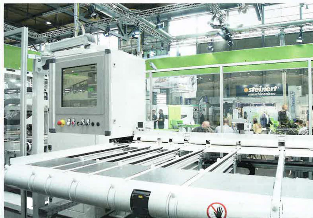
TRC 1500 pozwala po raz pierwszy na całkowicie automatyczną naprawę warstw wierzchnich. Obróbce można poddać powierzchnie drewniane o długości 500 - 3000 mm, szerokości 100 - 350 mm oraz grubości 3 - 30 mm. Fot. Alicja Bagnucka
