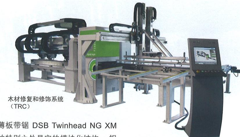
薄板带锯 DSB Twinhead NG XM 的特别之处是它的模块化结构 – 锯条可根据客户需求进行扩展。它还有许多其他优点，比如结构紧凑、单班可达 12,000 平方米的极高产能和灵活性。同时，该设备能够根据木块尺寸和薄板强度进行更快速地设置，切割的应用范围显著扩大，可用于更广泛的领域。
