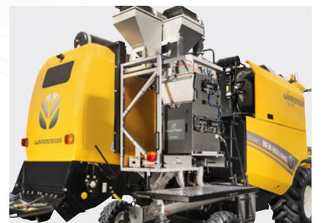
Système de pesage Twin H2 haute performance de HarvestMaster, avec des données précises de pesage, d'humidité et de poids volumique
