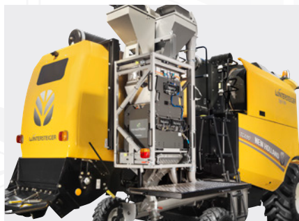
HarvestMaster 性能强大的称重系统 Twin H2, 可提供精确的称量、湿度和体积重量数据
