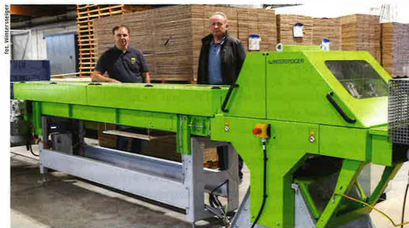
Zainstalowany kilka tygodni temu w firmie Tilo mechaniczny system pomiaru i sortowania górnej warstwy deski podłogowej.
