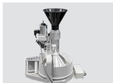
Conede correia com distribuição longitudinal aprimorada e resistência a desgastes
