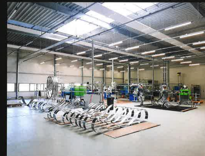
Bandsägeblätter vor der neu geschaffenen Maschinengruppen für den Sägenservice.
