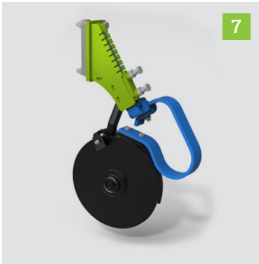
MONOSEM 双圆盘施肥开沟器 多功能双圆盘施肥开沟器非常适合于最小化耕作和处理植物表层残留物。插入元件具有带弹簧复位功能的防石子保护装置，并可调节工作深度
