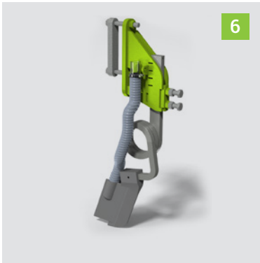
靴式施肥开沟器 结构简单的靴式施肥开沟器适用于有机质含量低的且准备充分的土壤。
