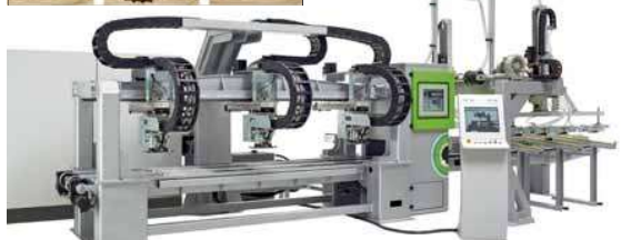
Vollautomatische Holzaußerbesserungsanlage Wintersteiger-TRC 3000 mit Schadstellenscanner. Bild oben (von links): Fehlstellen jeweils in rohem, ausgelesenen und geschliffenen Zustand. Fotos: Wintersteiger
