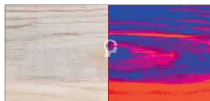
In der hyperspektralen Bildgebung mit Bläue kontaminierter Bereich (blau dargestellt) Fotos: Perception Park
