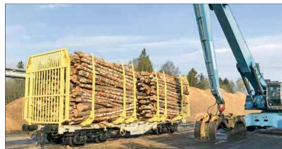
Der Eisenbahnwagon „Golden Bullet 2.0“ wurde von den schwedischen Firmen Green Cargo und Exte Fabriks entwickelt und kommt nun zum ersten Mal in der Rundholzlogistik für Holmen zum Einsatz. Foto: Green Cargo
