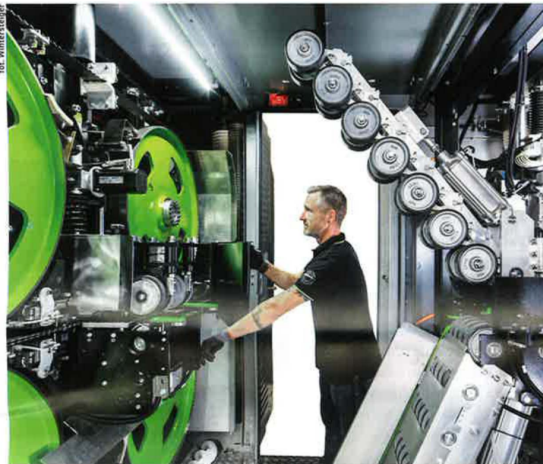
Gwarancją dokładności cięcia jest także stabilne przyłożenie długich bloków materiału na wejściu i wyjściu z maszyny do bazy.
