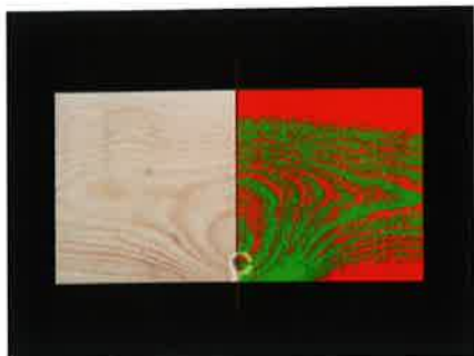
Cernes de croissance [détection du duramen/de l'oublier] Détection du bois de printemps et du bois d'été parmi les cernes de croissance - (Photo : Perception Park)
