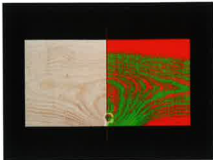
Groeiringen (detectie van kernhout/spinhout) Detectie van lente- en zomerhout bij de groeiringen [Foto: Perception Park]
