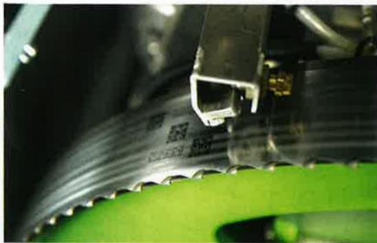
**Zu den digitalen Erweiterungen zählen unter anderem die automatisierte Sägeblatterkennung und die Blockbreitenmessung.**
