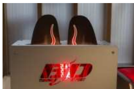
Parallel dazu werden die Einlagen im BD Speed Heat 25 Sekunden lange erhitzt.
