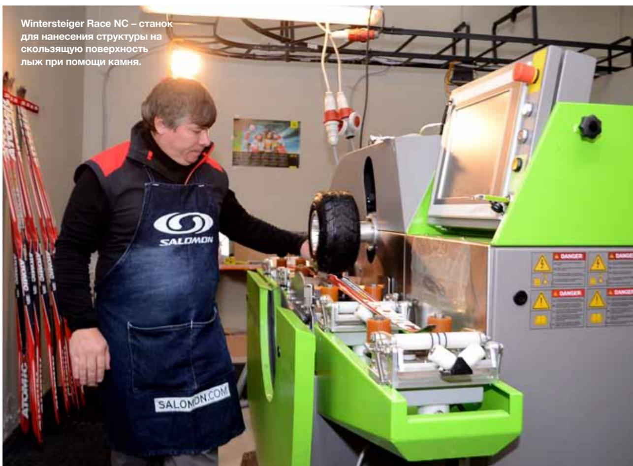
Wintersteiger Race NC – станок для нанесения структуры на скользящую поверхность лыж при помощи камня.
