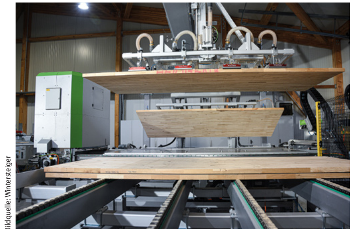
Die TRC Panel 2000 hebt mühelos Platten bis 150 kg
