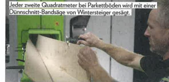
Jeder zweite Quadratmeter bei Parkettböden wird mit einer Dünnschnitt-Bandsäge von Wintersteiger gesägt.
