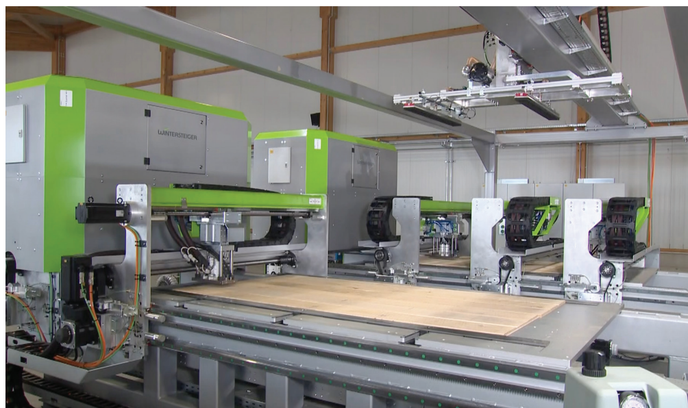
TRC Panel 3TH w pełni zautomatyzowanym procesie naprawia kilka desek jednocześnie, umożliwiając efektywną i dokładną obróbkę. Fot. Wintersteiger
