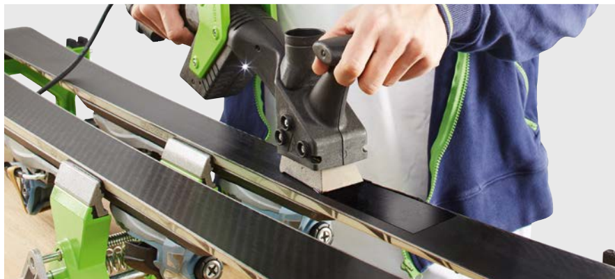
Aufschmelzschuh mit größerer Auflagefläche
