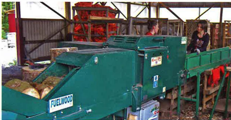
Automat do przygotowania podpałki Kindlet PRO pozwala wykonać w ciągu jednej zmiany 2000 worków podpałki.
