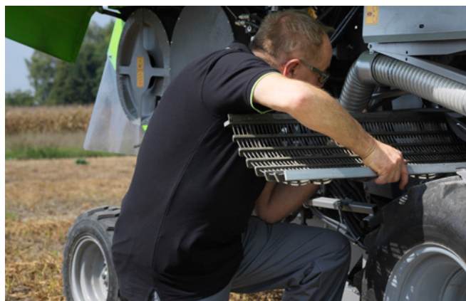
Changement facile des cassettes de contre-batteur
