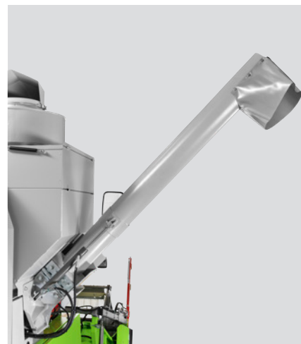
Coclea di scarico del cassone granella con funzionamento idraulico
