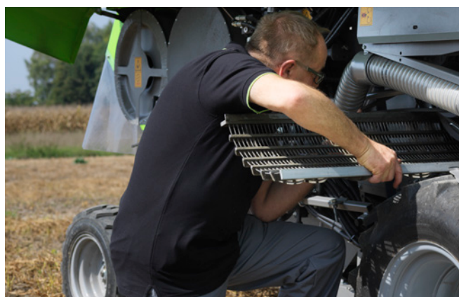
Sostituzione semplice e rapida del controbattitore
