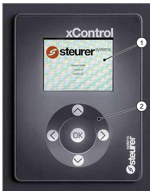
Después de la conexión, aparece la siguiente ventana de inicio. Esta ventana cambia al cabo de algunos segundos a la ventana principal para que usted pueda realizar sus ajustes individuales en el aparato.
