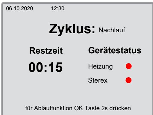
Nach jedem Zyklus läuft das Gebläse des Trocknungsschrances 15 Minuten lang nach (Standardeinstellung) um das Gerät auszukühlen.
