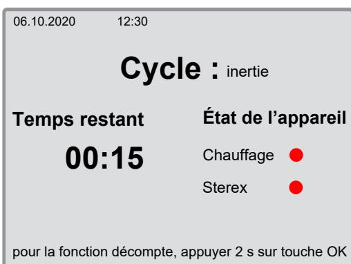
En fonction du cycle, la soufflerie de l'armoire de séchage fonctionne pendant 15 minutes (réglage par défaut) pour refroidir l'appareil.
