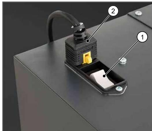
Главный выключатель [1] расположен рядом со штекерным соединителем устройства [2] и одновременно выполняет функции предохранительного выключателя.
