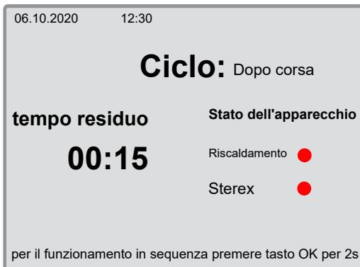
Dopo ogni ciclo, il ventilatore del sistema di asciugatura funziona per 15 minuti (impostazione standard) per raffreddare l'apparecchio.
