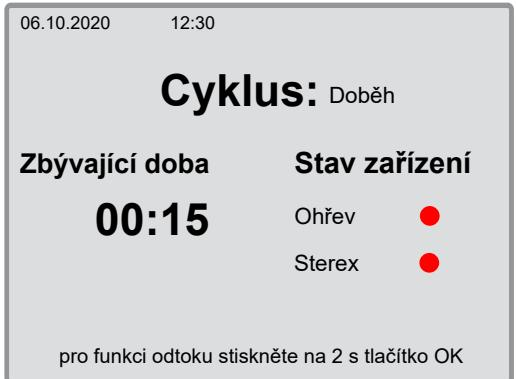
Po každém cyklu běží ventilátor sušicí skříně ještě 15 minut (standardní nastavení), aby se zařízení ochladilo.
