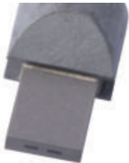
Rectangular diamond dresser 2 x 0,3 x 1,5 mm, Total bearing surface 0,9 m 2 , r = 0,14 mm
