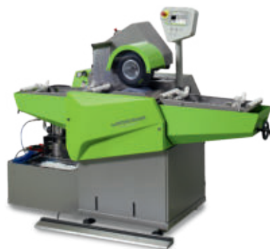
Omega RS 150, RS 350 Ponceuse pierre seule pour skis et snowboards. / Stone Grinder for skis and snowboards.
