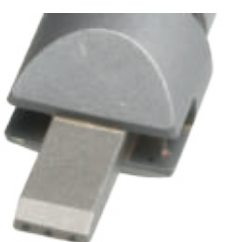
Diamond dresser Rhomboid 3 x 0,4 x 0,4 mm, Total bearing surface 0,48 mm 2 , r = 0,25 mm
