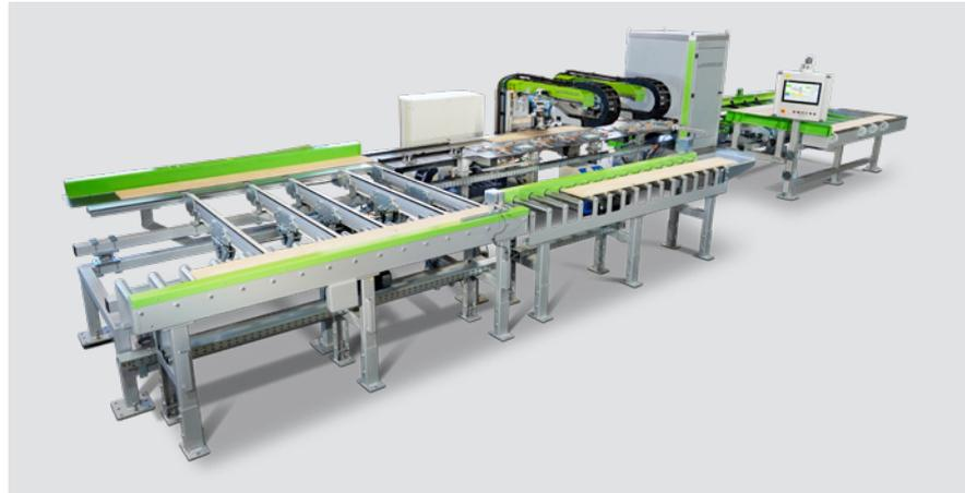
Die TRC Board ist optional auch mit einem Stirnlineal ausgestattet, d.h. auch Risse an der Stirnseite des Materials werden präzise vermessen und repariert.
