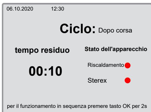
Dopo ogni ciclo, il ventilatore del sistema di asciugatura funziona per 10 minuti (impostazione standard) per raffreddare l'apparecchio.
