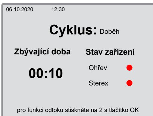
Po každém cyklu běží ventilátor sušící skříně ještě 10 minut (standardní nastavení), aby se zařízení ochladilo.
