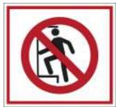
Během provozu zařízení se ve vnitřním prostoru zařízení nesmí nacházet žádná osoba. Nezavírejte dveře, pokud se v zařízení zdržují osoby!
