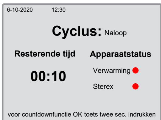
Na elke cyclus draait de ventilator van de droogkast nog tien minuten door (standaardinstelling) om het apparaat af te koelen.
