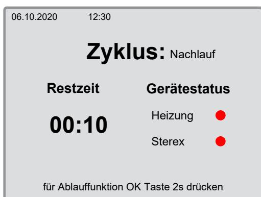
Nach jedem Zyklus läuft das Gebläse des Trocknungsschrances 10 Minuten lang nach (Standardeinstellung) um das Gerät auszukühlen.
