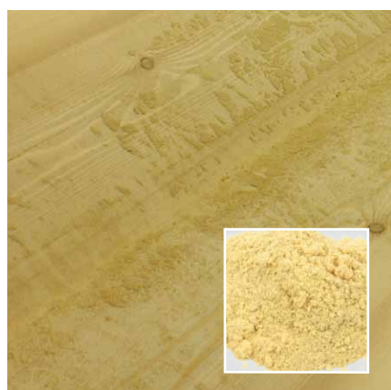
Staubanfall mit Standardsäge
