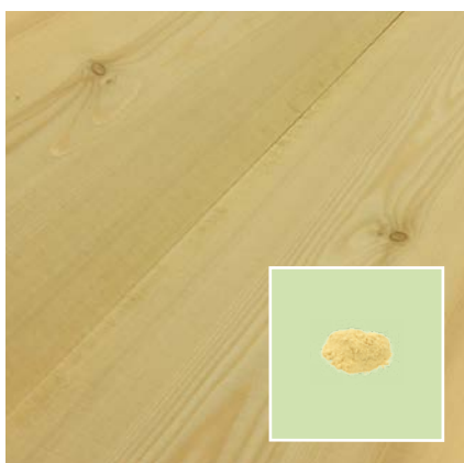
Production de poussière avec scie DSB X-Clean
