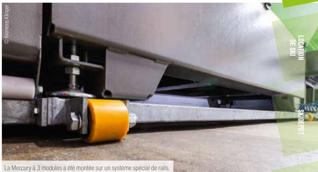
La Mercury à 3 modules a été montée sur un système spécial de rails.
