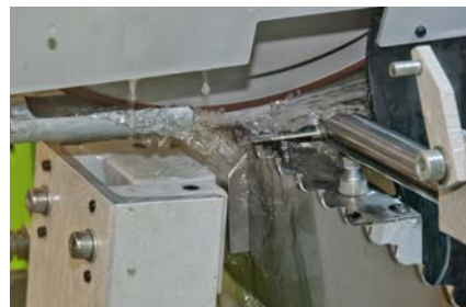
Ściernica, układ chłodzenia brzeszczotu
