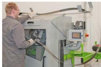
Zakładanie brzeszczot taśmowy
