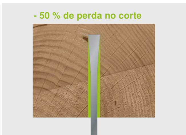
Corte fino de alta qualidade com espessuras de corte estreitas e alta precisão
