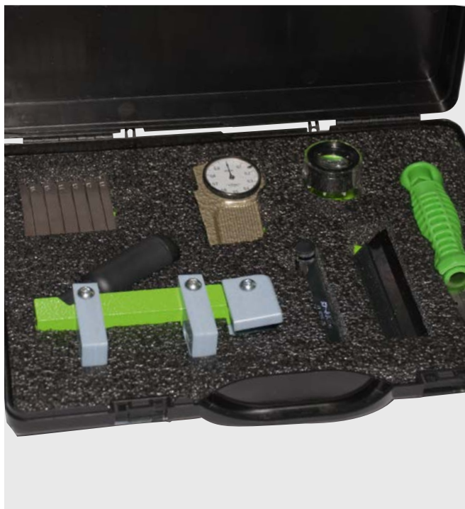
Шаблон для контроля величины развода зубьев
