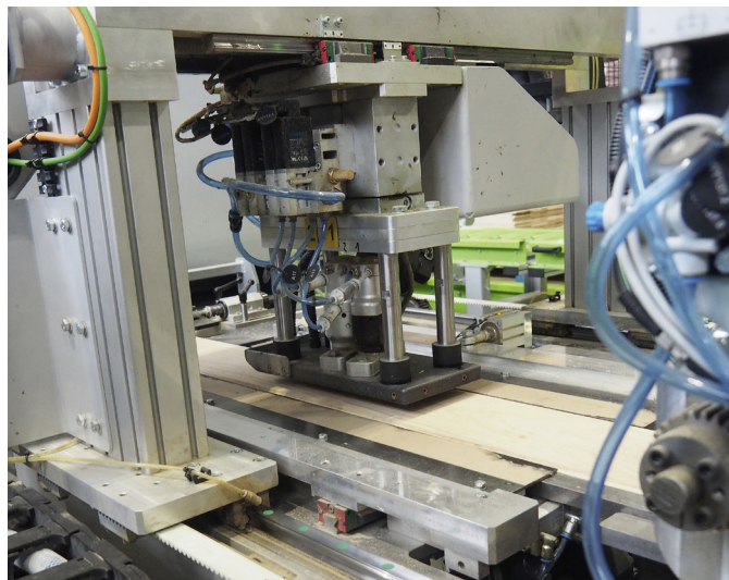
Der Injektionskopf an der TRC 1500 füllt die größeren Risse und Astlöcher, zusätzlich ist ein Applikationskopf für kleinere Fehlstellen im Einsatz
