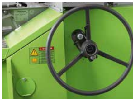
Вариатор молотильного барабана
