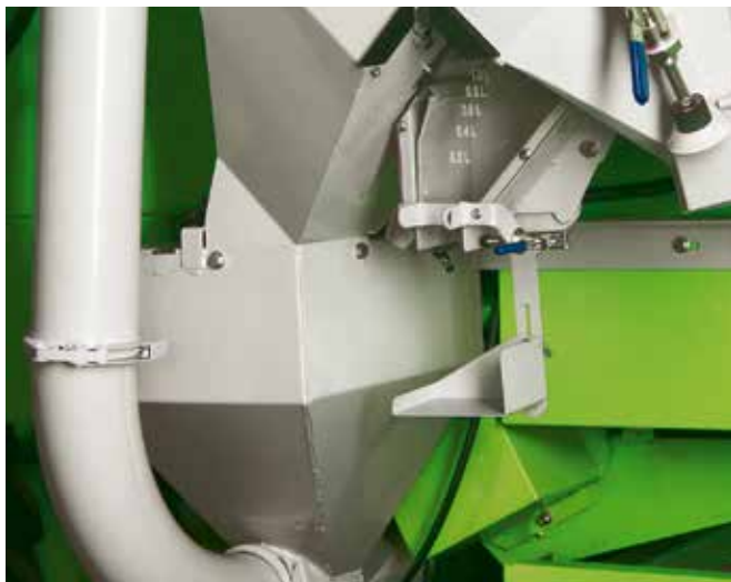
Отбор проб с боковой стороны (комбайнер + оператор)
