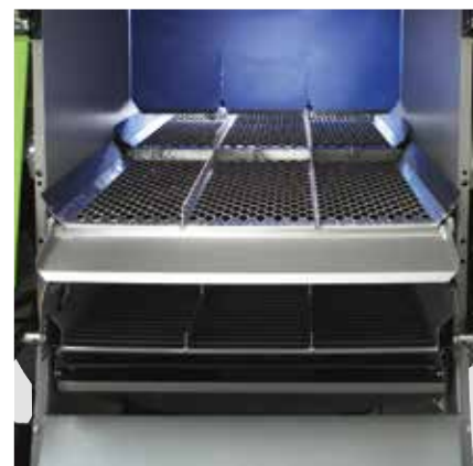
Плоскорешетный соломотряс и очистительные сита
