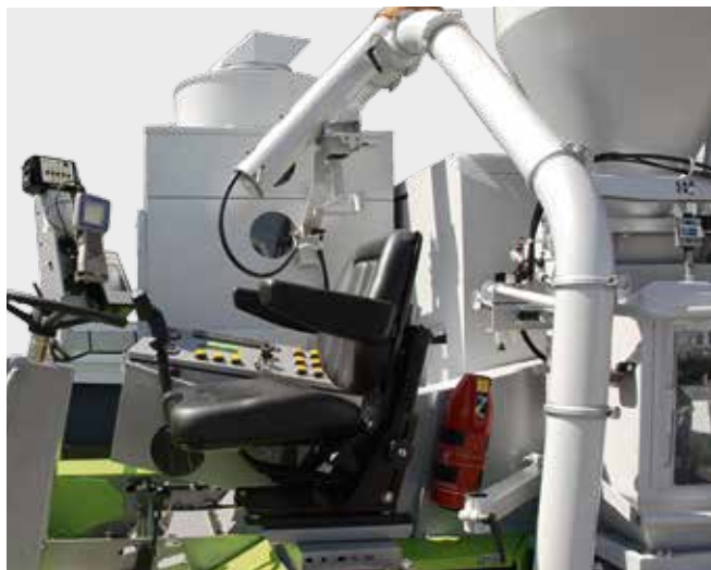
Отбор проб рядом с местом водителя (комбайнер)
