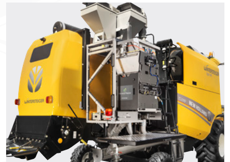
Leistungsfähiges Wiegesystem Twin H2 von HarvestMaster, mit präzisen Wiege-, Feuchte- und Volumengewichtsdaten
