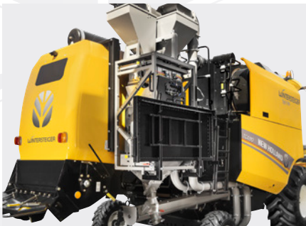
Leistungsfähiges Wiegesystem Twin H2 von HarvestMaster, mit präzisen Wiege-, Feuchte- und Volumengewichtsdaten
