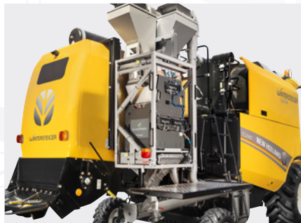
Leistungsfähiges Wiegesystem Twin H2 von HarvestMaster, mit präzisen Wiege-, Feuchte- und Volumengewichtsdaten
