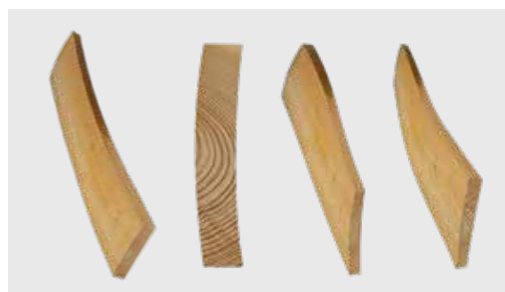
Blocos com curvatura longitudinal ou transversal, deformação ou torção
