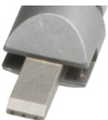
Diamond dresser Rhomboid 3 x 0,4 x 0,4 mm, Total bearing surface 0,48 mm 2
