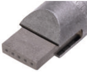
Diamond dresser Square 5 x 0,6 x 0,6 mm RC, Total bearing surface 1,8 mm 2
