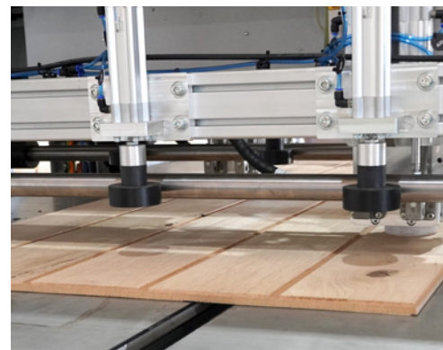
Naprawa desek parkietowych
