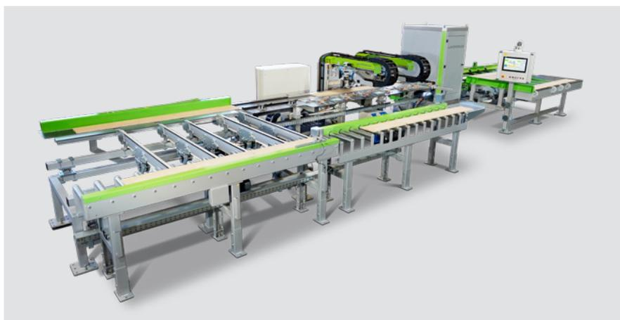
O TRC Board está opcionalmente equipado com uma régua frontal, ou seja, as fissuras presentes no lado da frente do material são também detetadas e reparadas com precisão. Além disso, todas as áreas danificadas nas áreas adjacentes diretas também podem ser preenchidas.
