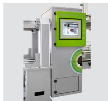
O Faulty Spot Eye (FSE) é adaptado a cada tecnologia de limpeza ou reparação sem quaisquer limitações, de forma a detetar sempre todas as áreas danificadas com precisão.
