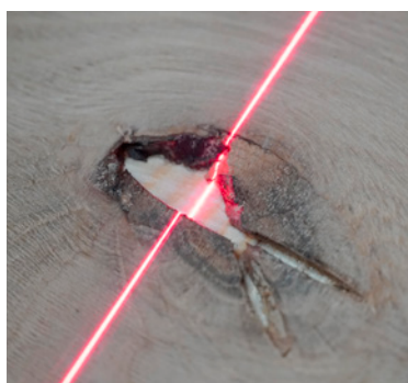
Сканер Faulty Spot Eye (FSE) специально разработан для обнаружения дефектов и служит частью технологии очистки и восстановления поверхности древесины.
