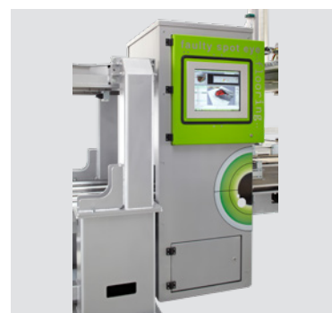
Сканер Faulty Spot Eye (FSE) специально разработан для обнаружения дефектов и служит частью технологии очистки и восстановления поверхности древесины.
