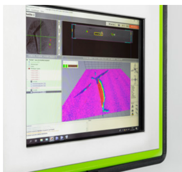
Сканер Faulty Spot Eye (FSE) специально разработан для обнаружения дефектов и служит частью технологии очистки и восстановления поверхности древесины.
