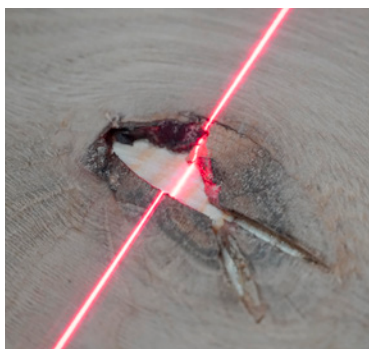
Faulty Spot Eye (FSE) 可以完全适用于任何清洁或修补技术，始终精确地检测出所有相关的缺陷。
