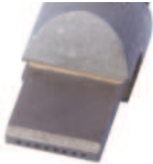
Rhomboid-Diamant 8 x 0,4 x 0,4 x 5 mm, Gesamt-Tragfläche 1,28 mm², r = 0,25 mm
