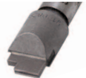
Plättchen Diamant 1 x 0,5 x 4,0 mm RC, Gesamt-Tragfläche 2,0 mm², r = 0,30 mm
