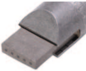
Quadrat- Diamant 5 x 0,6 x 0,6 mm RC, Gesamt-Tragfläche 1,8 mm², r = 0,36 mm
