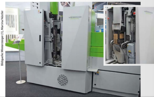
Das Dünnschnittgatter des Typs DSG Notum Pro überzeugt mit minimaler Schnittfuge und hoher Energieeffizienz
