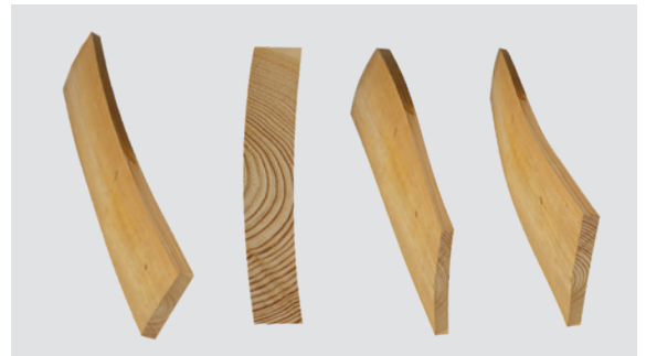
Blöcke mit Längs- oder Querkrümmung, Schüsselung oder Verwindung
