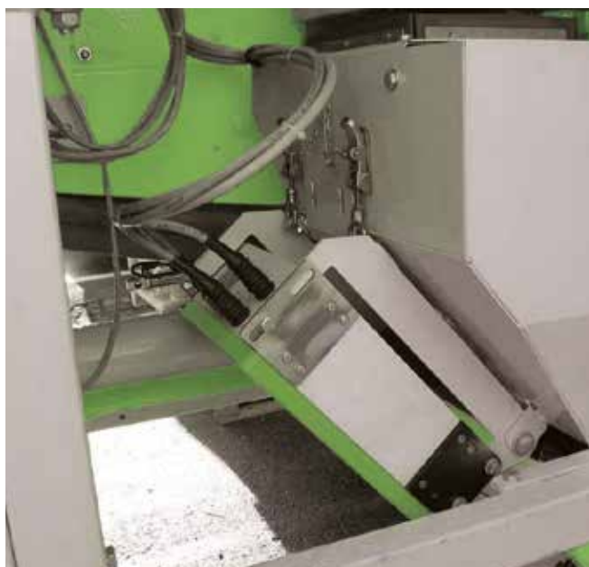
Sistema di misurazione NIRS montato sul sistema di pesatura
