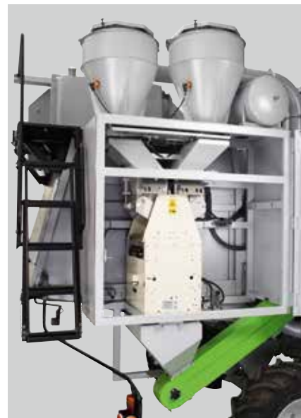
Se abren los 2 recipientes previos y el producto cosechado cae en el recipiente de pesaje
