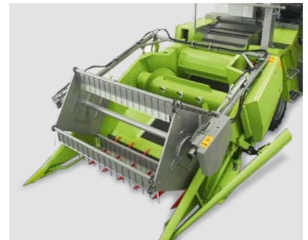
Mecanismo de corte com esteira alimentadora
