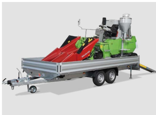
No reboque, estão armazenadas duas rampas de acesso em alumínio, que permitem carga e descarga rápidas. As paredes laterais, em alumínio, com fechos embutidos podem ser dobradas e retiradas. O engate do reboque de esferas possui um servo-freio de inércia e uma função automática de marcha a ré.
