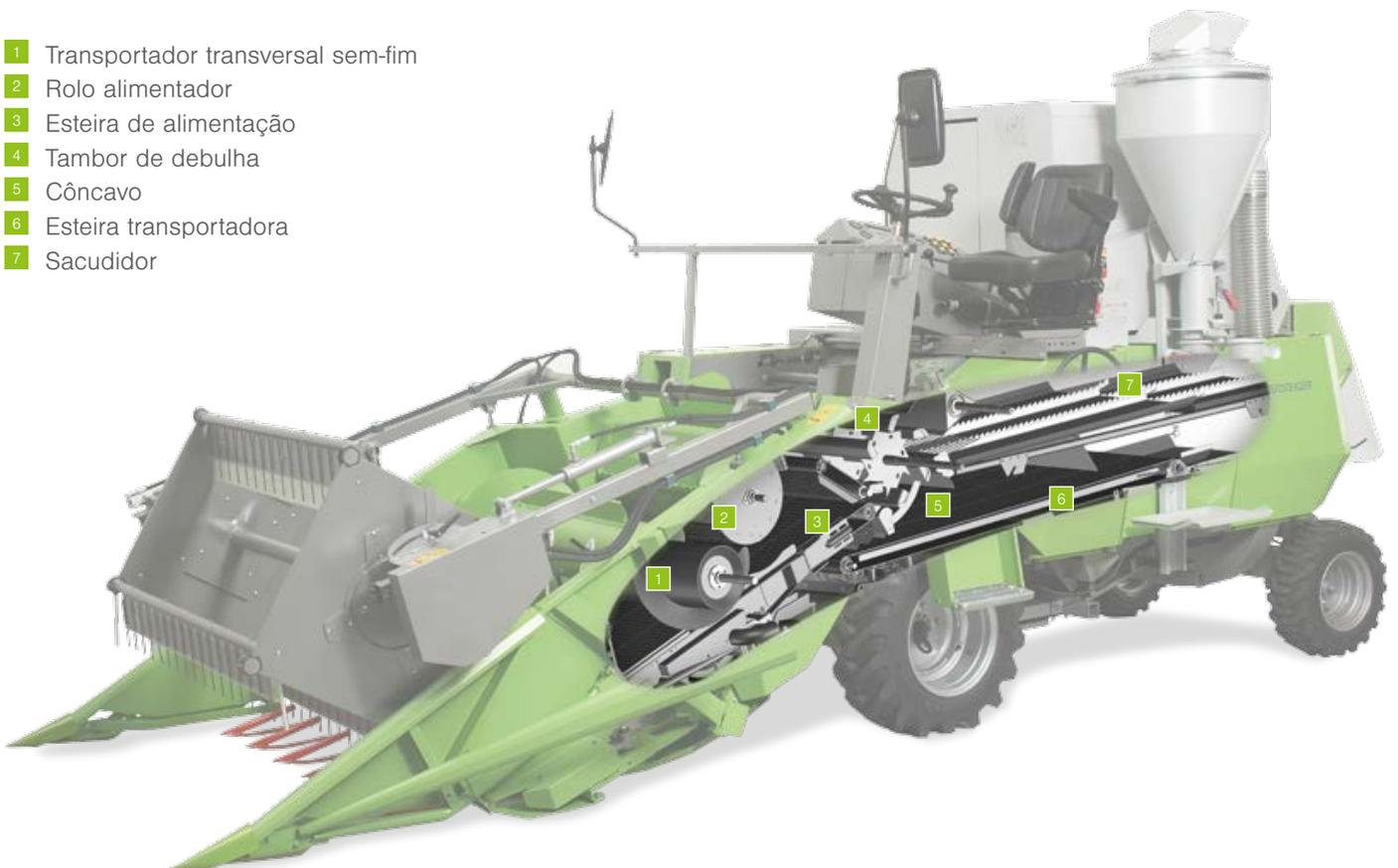
Esteira transportadora, tambor de alimentação, rolo alimentador, tambor de debulha, sacudidor, peneira, piso de preparação, ventilador - a seleção perfeita dos componentes mais importantes em combinação com o transporte pneumático de grãos garantem uma debulha eficiente e sem misturas
