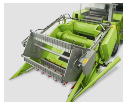
Жатка с ленточным транспортером
