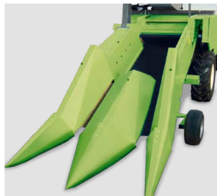
Адаптер жатки для уборки широкорядных посевов
