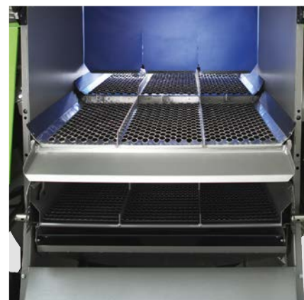
Плоскорешетный соломотряс и очистительное сито
